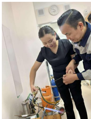
Зураг 8. Эмнэлгийн тоног төхөөрөмжийн инженер техникч нар хүйтэн хэлхээний тоног төхөөрөмжийн гагнуур хийж буй нь
